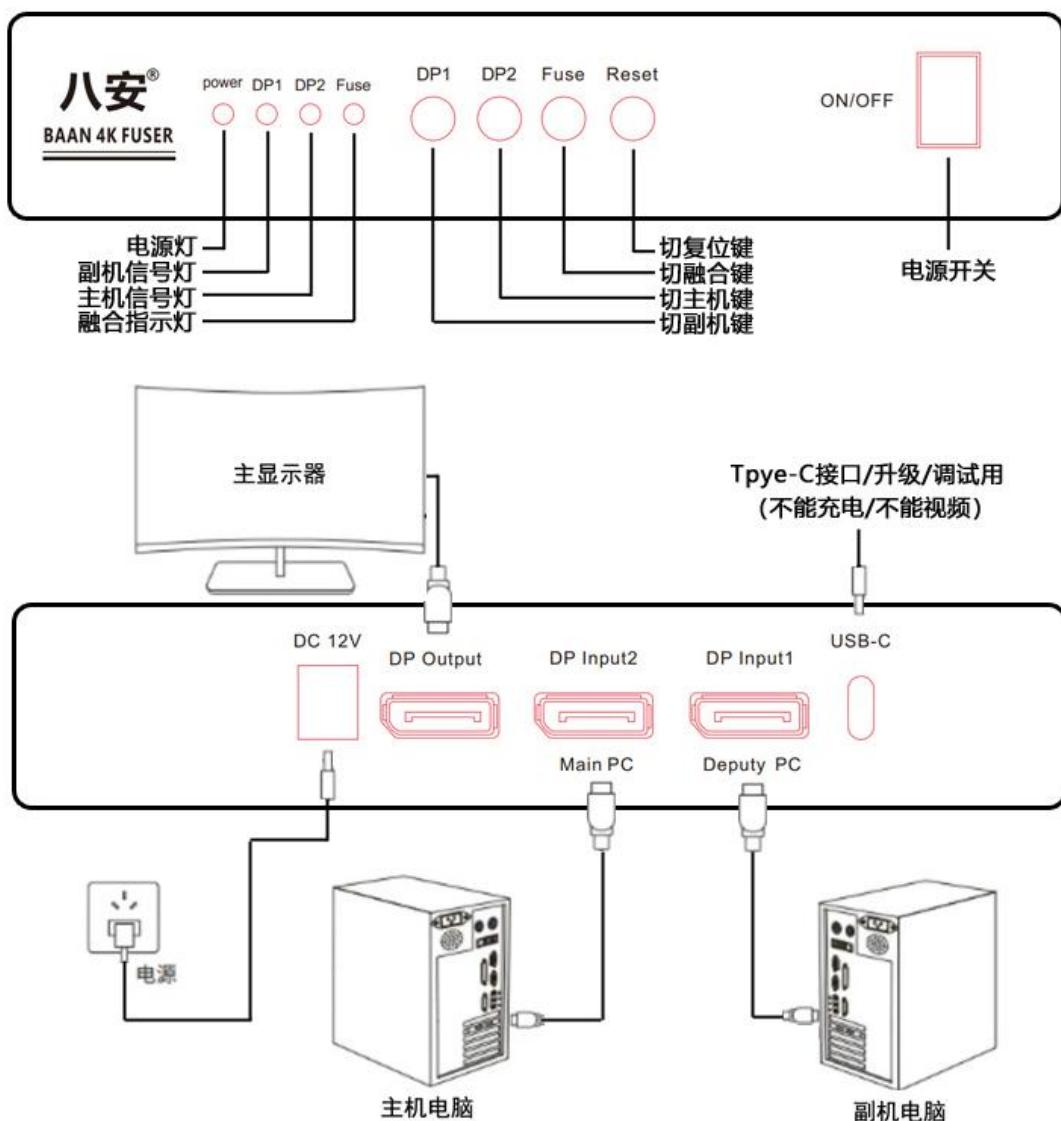
1，按上面连接图，把 3 根 DP 线和电源线对应插好。确认好后，2 台电脑和显示器先通电开机。等开机正常后，融合器最后上电开机。
